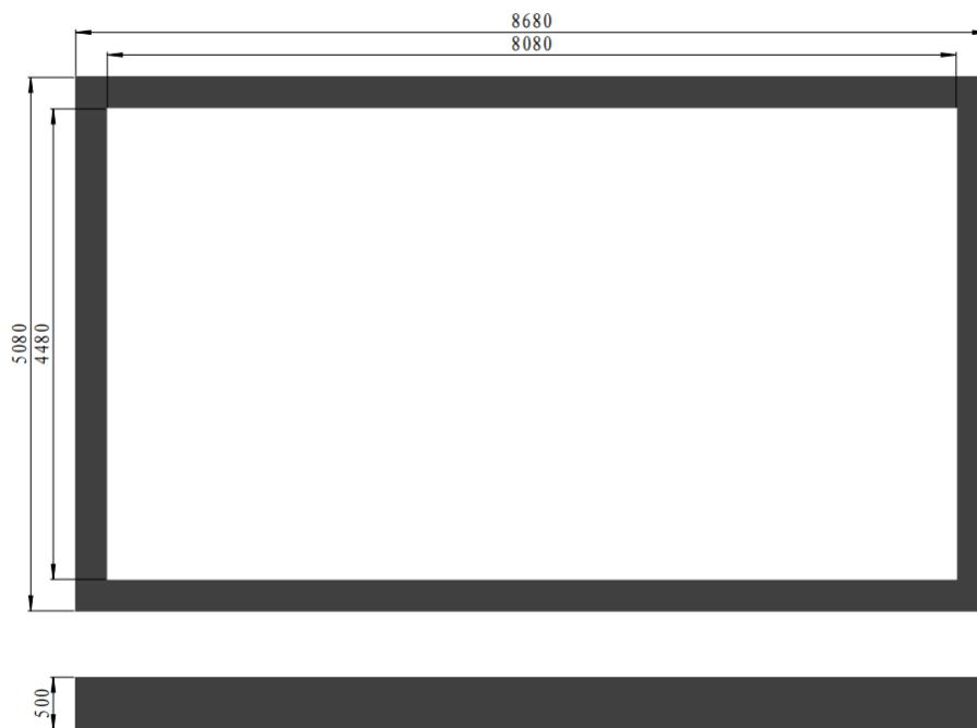
图 2-9 保护围挡区尺寸图
